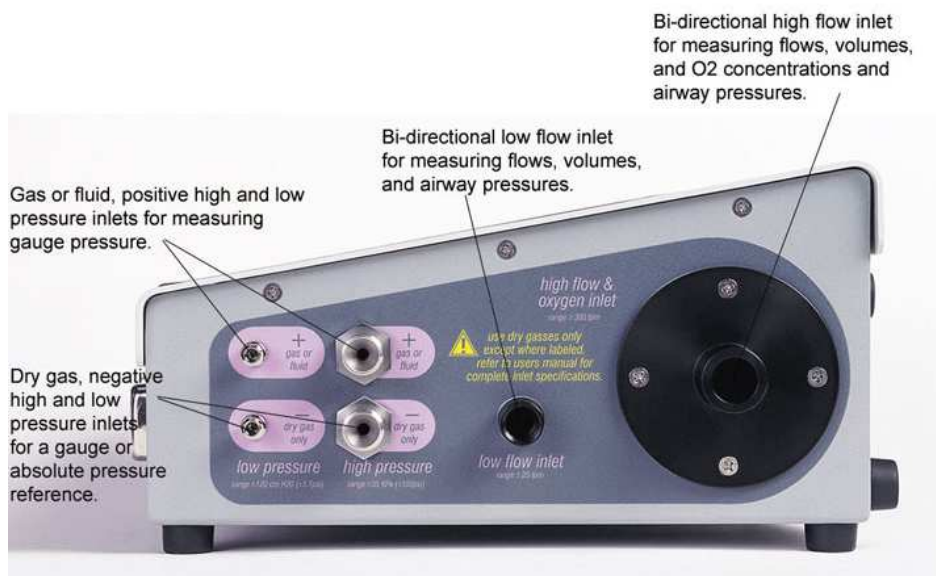
Figur 2. VT Plus HF 's tryck- och flödesingångar.
